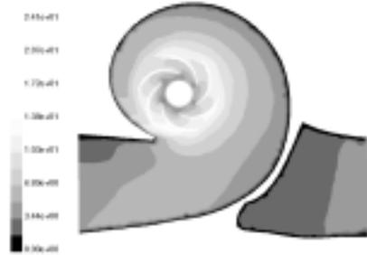
图 3 泵的速度分布(m/s)
