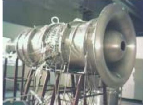
图 1 三级低速轴流压气机试验件
