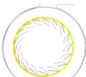
图 5 对称蜗壳叶轮出口静压云图
