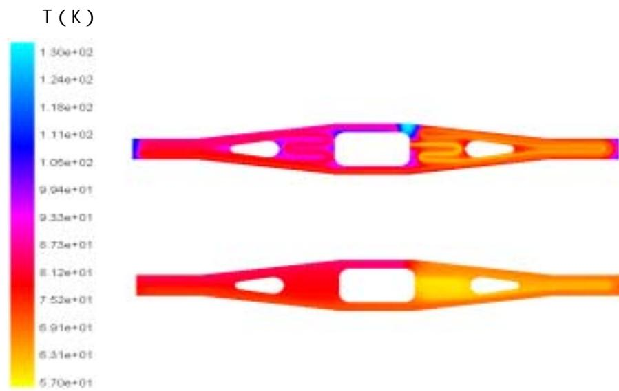
图 3.1 内冷屏表面温度分布图
