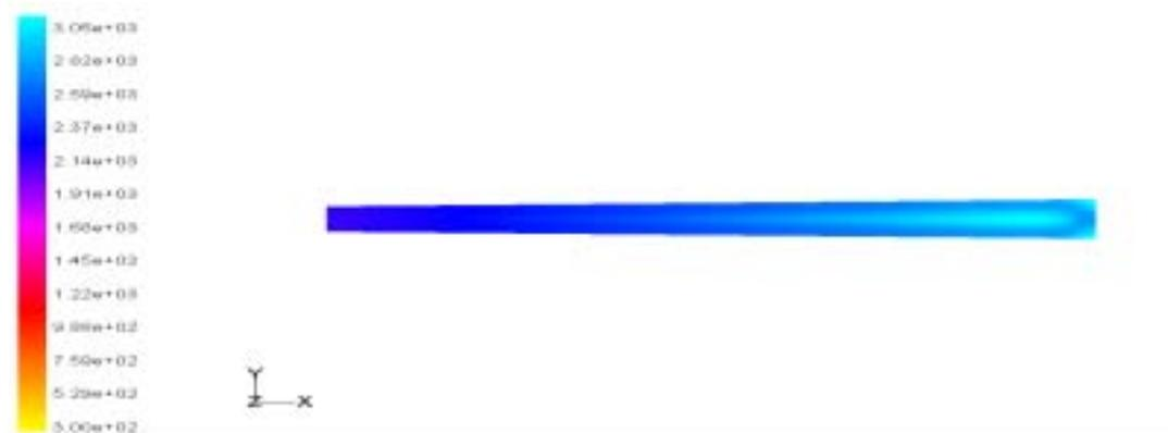
图 3.3 内部构件底面温度分布图 (A 方案，流量 3.0Kg/s)
