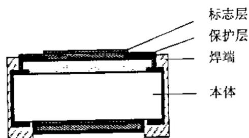
图 A.4 无引脚矩形片状元件示意图
